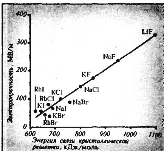
Рис. 3. График зависимости электропрочности щелочногалоидных ионных кристаллов от энергии связи кристаллической решетки.
